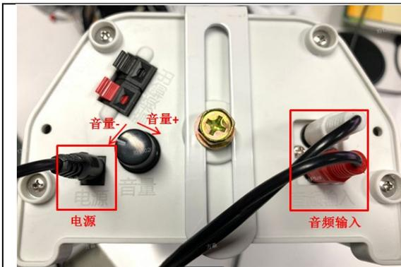
步骤一：连接电源和音频输入线（均自带，无需另购置）
