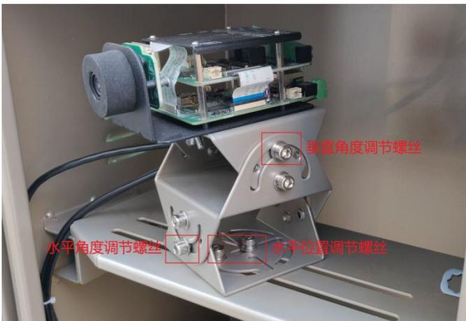
2、相机和三维支架会安装在底座的限位标识上；左定右向、右定左向，安装位置会有差异，请安装时注意区分。
